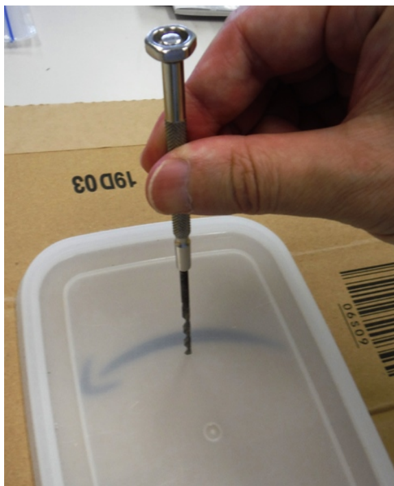
ドライバータイプのドリルでLEDの取り付け穴をあける
